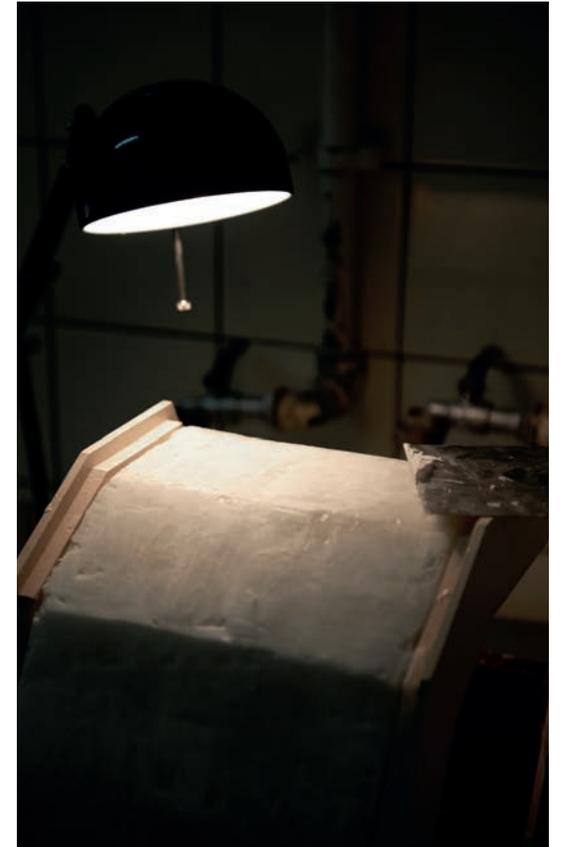
Um die gewünschte Struktur zu erreichen, wurden zusätzliche Wachsschichten auf das Objekt aufgebracht und mit einem Spachtel modelliert. Dies hatte zudem den Vorteil, das Schrumpfverhalten des Wachses auszugleichen. Hierbei diente die Gussform als Maß und Stand. Um das Wachsmodell genau zu begradigen, wurde eine Grillplatte zu Hilfe gezogen.
