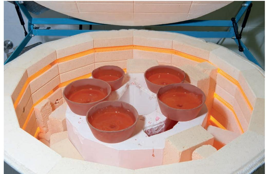
Nachdem der Ofen kontrolliert auf Arbeitstemperatur gebracht wurde, musste über mehrere Stunden hinweg die Ofenklappe geöffnet und manuell bei Temperaturen über 800 Grad Glas nachgelegt werden. Dies erfolgte in entsprechender Sicherheitsbekleidung.
