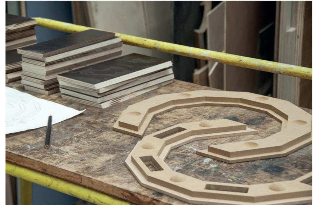
Deutlich aufwendiger gestaltete sich dem gegenüber die Konstruktion und Umsetzung der Wachsgussform. Wie in Kapitel 3 bereits erläutert, ist für das Glasgussverfahren ein Positiv aus leicht schmelzbarem Wachs notwendig, um komplexe Gipsformen mit Hinterschneidungen erstellen zu können. Um nicht für jeden Glasguss das Wachsmodell aufs Neue modellieren zu müssen, empfiehlt es sich bei zu replizierenden Arbeiten eine Masterform für das Gießwachs zu erstellen.
